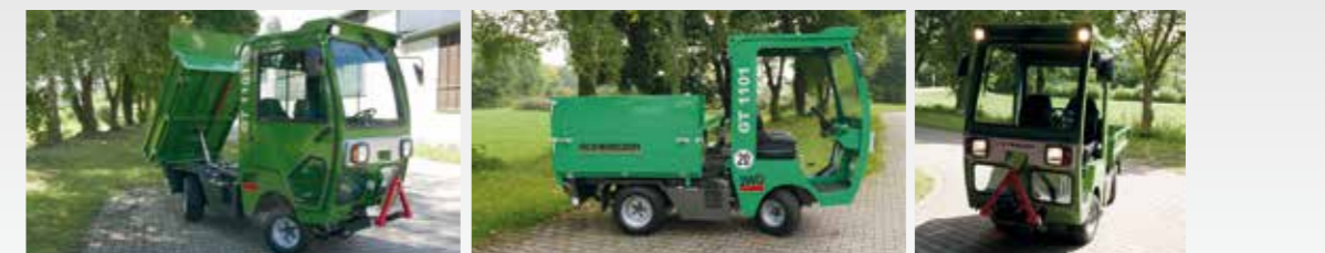
Dreiseitenkipper in Stahl und Aluminium ausgeführt
