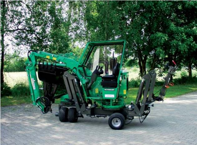
Unübertroffen wendig, bequem steuerbar durch hydraulische Servolenkung
